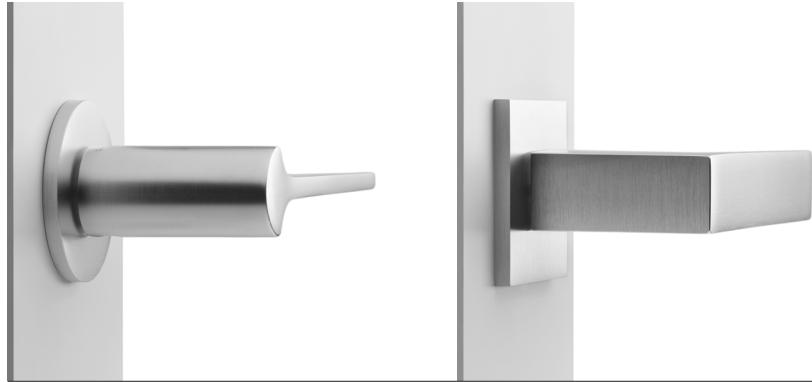
Il sistema Less is fine – di soli 4 mm – nasce grazie alle nuove tendenze dell'architettura. In soli 4 mm si trova la rosetta metallica con molla uni-direzionale destra o sinistra – a compressione –, la quale permette un'installazione senza lavorazioni aggiuntive sulla porta. Brevetto Dnd.
